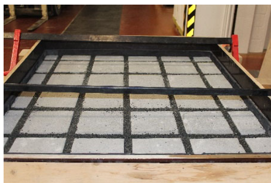
Matériau de jointoiement mis en place
